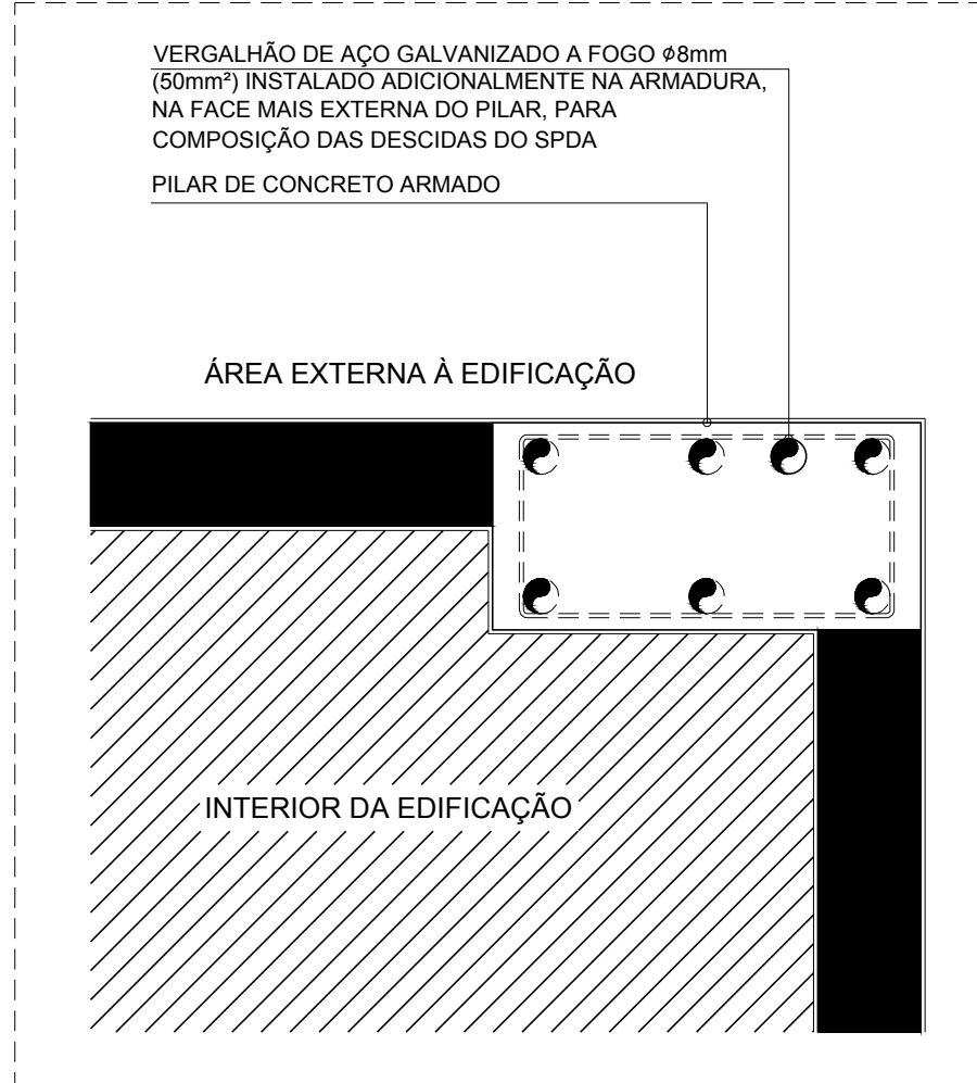
DET. 03 INSTALAÇÃO DO VERGALHÃO DE DESCIDA DO SPDA SEM ESCALA
